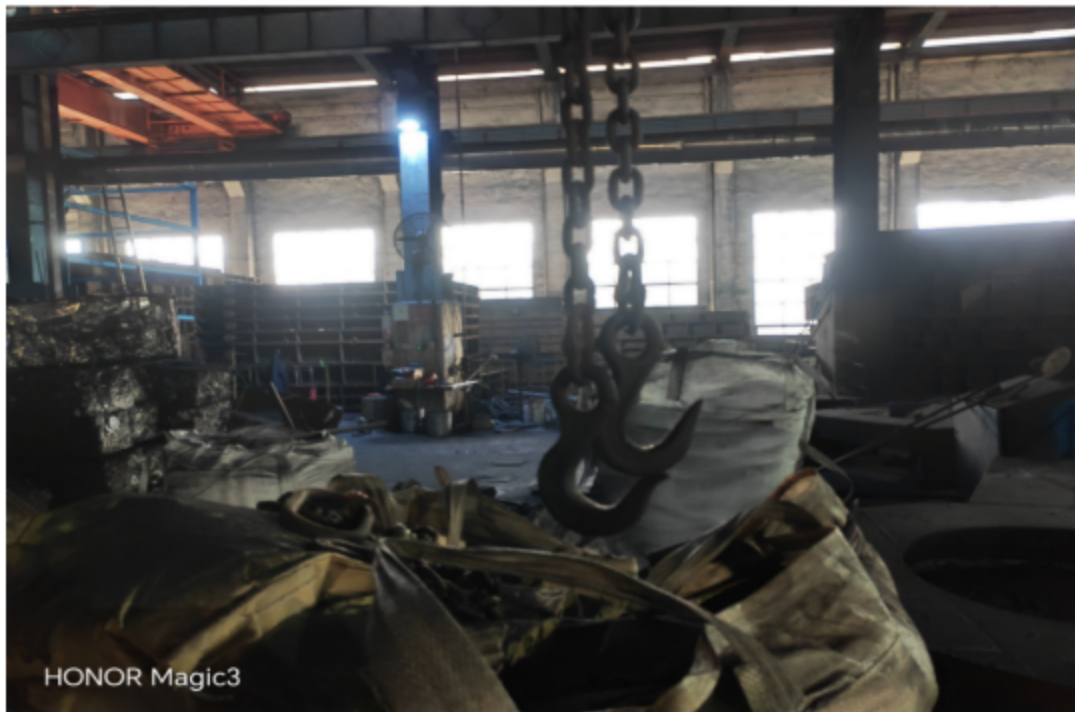
(图5 普通门式起重机吊钩未安装防脱钩装置)
